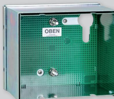
Der VdS-geprüfte Tiefenausgleichsadapter EZTA950-1 wurde entwickelt, um das Feuerwehr-Schlüsseldepot auch in Gebäudewänden mit unterschiedlichen Dämmstärken von 180 bis 305 mm (Verstellbereich 125 mm) sicher befestigen zu können.
