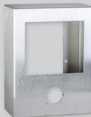
Der vom VdS zugelassene Schlüsseldepot-Adapter AD900-1 ist das Bindeglied zwischen dem Feuerwehr-Schlüsseldepot und der Brandmelder- bzw. Einbruchmeldezentrale. Der Adapter überwacht das SD950 und entriegelt im Einsatzfall dessen Außentür. Bei einem Aufbruchversuch wird eine Sabotagemeldung ausgelöst. Die optischen Anzeigen für die Funktionen "Betrieb", "SD-Alarm", "SD entriegelt" und "Objektschlüssel entnommen" geben jederzeit einen Überblick über den Status des Systems.
