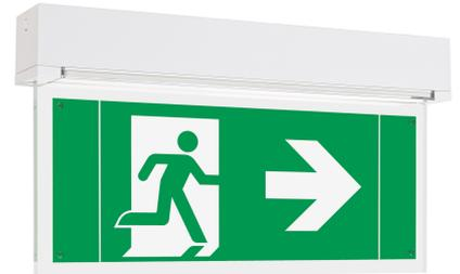
Die kombinierte Rettungszeichen- und Sicherheitsleuchte VARIOUS200 mit zentraler Stromversorgung ist nach EN60598-1/2-22 und EN 1838 ausgeführt und wird in Sicherheitsbeleuchtungsanlagen gemäß EN 50172 eingesetzt.
