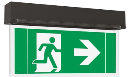
Die kombinierte Rettungszeichen- und Sicherheitsleuchte VARIOUS200 mit Einzelbatterie-Versorgung ist nach EN60598-1/2-22, EN62034 und EN1838 ausgeführt und ist zur Verwendung in Sicherheitsbeleuchtungsanlagen gemäß EN50172 vorgesehen.
