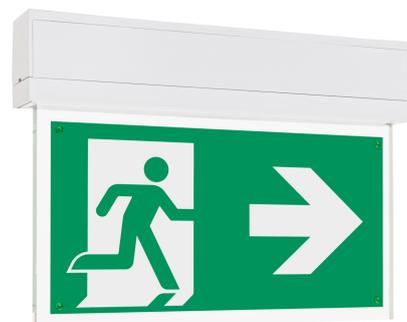
Die Rettungszeichenleuchte UNI200 mit Einzelbatterie-Versorgung nach EN 60598-1/2-22, EN 62034 und EN1838 ist zur Verwendung in Sicherheitsbeleuchtungsanlagen gemäß EN 50172 vorgesehen.
