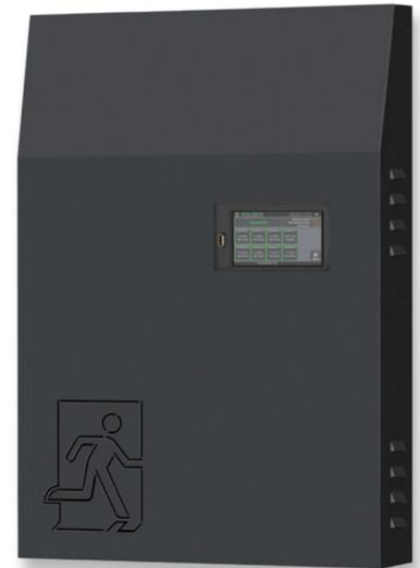
Die Gruppenbatteriezentrale dient der Realisierung von Sicherheitsbeleuchtungsanlagen nach EN 50172. Darüber hinaus kann sie für die Versorgung von Sicherheits- und Rettungszeichenleuchten mit 230 VAC / 220 VDC Spannung nach EN 50171 verwendet werden.
