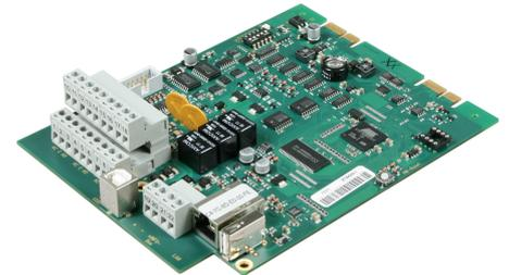
Die Zentralbaugruppe ZTB600-1 wird zum Einbau in eine Brandmelderzentrale BC600-xxxN (Lieferung ohne Zentralbaugruppe) sowie zum Aufbau einer Brandmelderzentrale BC600-E in einem Schaltschrank verwendet.
