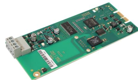
Das Serielle Interface SIF601-9 dient zur Erweiterung einer Brandmelderzentrale Serie BC600 um eine INFO-Bus-Schnittstelle bzw. die erweiterte INFO-Bus-EP-Schnittstelle.
