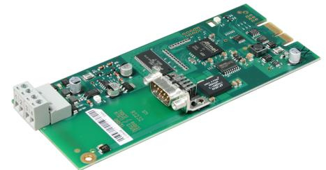
Das Serielle Interface SIF601 dient zur Erweiterung einer Brandmelderzentrale Serie BC600 um eine galvanisch getrennte RS232C-Schnittstelle oder alternativ um eine INFO-Bus-Schnittstelle bzw. die erweiterte INFO-Bus-EP-Schnittstelle.
