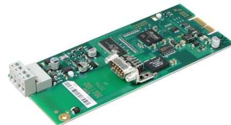
Das Serielle Interface SIF601 dient zur Erweiterung einer Brandmelderzentrale Serie BC600 um eine galvanisch getrennte RS232C-Schnittstelle oder alternativ um eine INFO-Bus-Schnittstelle bzw. die erweiterte INFO-Bus-EP-Schnittstelle.
