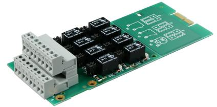
Die Relaisbaugruppe RL608-1 dient zur Schaltung von Verbrauchern über acht unabhängig voneinander ansteuerbare potentialfreie Kontakte. Je nach Anwendung können die Relaiskontakte individuell als Schließer, Öffner oder Schließer mit Meldewiderständen für die VdS-Löschsystem-Schnittstelle konfiguriert werden.
