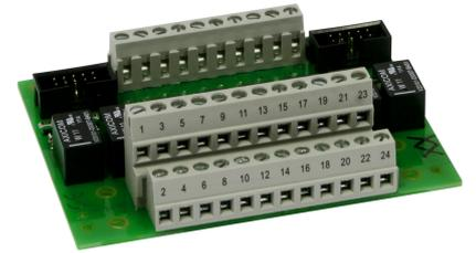
Die Brandmelderzentralen Serie BC600, Serie BC216 und Serie BC016 verfügen über frei programmierbare Open-Collector-Steuerausgänge. Jeweils 8 Open-Collector-Ausgänge sind auf einen Flachkabelstecker geführt. Die Relaisbaugruppen RL58-1 und RL58-2 ermöglichen die einfache Umsetzung dieser Steuerausgänge auf potentialfreie Umschaltkontakte.
