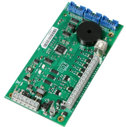
Die Paralleltableau-Umsetzeinrichtung PTU2882 ermöglicht die Ansteuerung von LED-Anzeige-Tableaus oder synoptischen Paralleltableaus. An die Paralleltableau-Umsetzeinrichtung können bis zu 3 LED-Anzeigebaugruppen LAB48-x oder LED-Anschlussmodule LAM48-1 in beliebiger Kombination angeschlossen werden.
