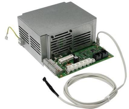
Das Netzteil NT608-1 dient zur Spannungsversorgung einer Brandmelderzentrale Serie BC600 und der daran angeschlossenen Zusatzeinrichtungen sowie zur Ladung der Notstrombatterien. Das Netzteil ist als Primär-Schaltregler mit hohem Wirkungsgrad ausgeführt, daraus resultiert eine geringe Eigenerwärmung und eine hohe Lebensdauer.
