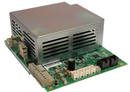
Das Netzteil NT604-1 dient zur Spannungsversorgung einer Brandmelderzentrale Serie BC600 und der daran angeschlossenen Zusatzeinrichtungen sowie zur Ladung der Notstrombatterien. Das Netzteil ist als Primär-Schaltregler mit hohem Wirkungsgrad ausgeführt, daraus resultiert eine geringe Eigenerwärmung und eine hohe Lebensdauer.
