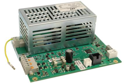
Die Netzgeräte Serie NT624 dienen zur sicheren Versorgung von Geräten, die eine Nennspannung von 24 VDC benötigen. Zu den typischen Einsatzgebieten zählen Brandmeldeanlagen und Löschstuerungen oder beliebige andere Anwendungen, die eine sichere Spannungsversorgung benötigen.
