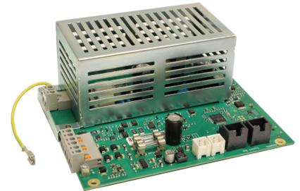
Das Netzteil NT602-1 dient zur Spannungsversorgung einer Brandmelderzentrale Serie BC600 und der daran angeschlossenen Zusatzeinrichtungen sowie zur Ladung der Notstrombatterien. Das Netzteil ist als Primär-Schaltregler mit hohem Wirkungsgrad ausgeführt, daraus resultiert eine geringe Eigenerwärmung und eine hohe Lebensdauer.
