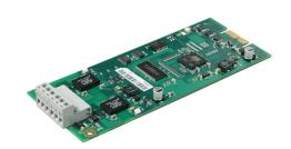
Das Netzwerk-Interface dient zur Vernetzung der Teilzentralen einer Brandmelderzentrale BCnet600 oder anderer net600-Teilnehmer über das Zentralennetzwerk net600. Die Baugruppe wird zum Aufrüsten einer Brandmelderzentrale Serie BC600 zu einer BCnet-Teilzentrale benötigt.
