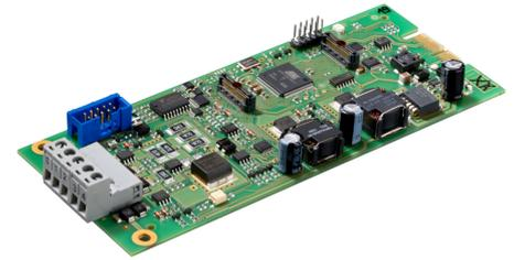
Das Loop-Interface LIF601-1 ermöglicht den Anschluss eines intelligenten Loops mit bidirektionalem Datenverkehr an Brandmelderzentralen Serie BC600. Das Loop-Protokoll ist an der Zentrale parametrierbar und ermöglicht damit die Ankopplung unterschiedlicher Melderfabrikate an eine Zentrale.
