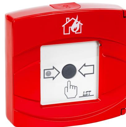
Der Handfeuermelder gemäß EN54-11/TypB wird über eine Grenzwert-Meldelinie an die Brandmelder- oder Löschsteuerzentrale angeschlossen. Das Normsymbol für Handfeuermelder ist auf der Tür aufgedruckt.
