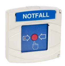
Der Notfallmelder dient gemäß DIN VDE V 0827-1 zur manuellen Auslösung einer Alarmmeldung im Falle eines akuten Notfalls oder einer Gefahr – z.B. Amokalarm oder Bombenalarm. Der Handmelder ist in Grenzwerttechnik ausgeführt. Er kann an Notfall- und Gefahren-Reaktions-Systeme (NGRS) beliebiger Hersteller angeschlossen werden.
