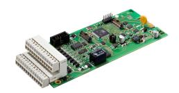
Das Feuerwehr-Interface FWI600-1 ist für den Anschluss einer Übertragungseinrichtung zur Verbindung mit einer hilfeleistenden Stelle sowie eines landesspezifi schen Feuerwehr-Bedienfeldes an Brandmelderzentralen Serie BC600 vorgesehen. Die 8 Eingänge und 10 Ausgänge können auch individuell parametriert werden und stehen so für allgemeine Steuerungsaufgaben zur Verfügung.
