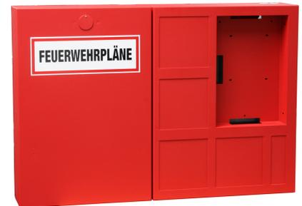
Die Feuerwehr-Informationszentrale FIZE3-1 bietet die Möglichkeit, einen Feuerwehr-Plankasten, ein Feuerwehr-Bedienfeld, das Steuerungszentralgerät und die Zustandsanzeige für den Feuerwehr-Schlüsselsafe sowie bis zu 4 Handmelder in einem optisch ansprechenden Metallschrank zu vereinen. Im Grundausbau ist nur der Feuerwehr-Plankasten und eine Klemmleiste im Inneren des Wandkastens enthalten. Die Einbauplätze für die optionalen Einrichtungen sind mit Blindplatten abgedeckt.
