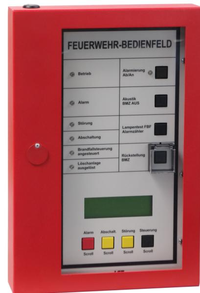
Das Feuerwehr-Bedienfeld FBF58-4 entspricht der „Variante C“ gemäß ÖNORM F 3031 und gewährleistet eine einheitliche Bedienung der Brandmelderzentrale durch die Feuerwehr. Es zeigt die wichtigsten Betriebszustände der Brandmelderzentrale mittels LEDs an und ermöglicht grundlegende Bedienhandlungen – beispielsweise das Rückstellen der Zentrale – über Tasten.
