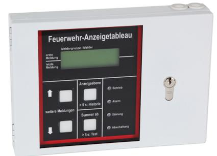
Das Feuerwehr-Anzeigetableau FAT950-1 entspricht der DIN 14662 und ermöglicht die akustische und optische Anzeige von Melder-, Meldergruppen- und Zentralenereignissen der Brandmelderzentrale an einer abgesetzten Stelle.
