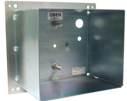
Die Einbauzarge aus verzinktem Stahlblech ermöglicht einen komplett versenkten Einbau eines Schlüsseldepots der Serie SD950 in Wände fester Bauweise (gemauert oder Beton). Die Einbauzarge wird in der Bauphase des Gebäudes eingemauert. Nach Abschluss der Bauarbeiten kann das Schlüsseldepot eingesetzt und verschraubt werden. Eine spätere Demontage des Depots ist ebenso einfach möglich.
