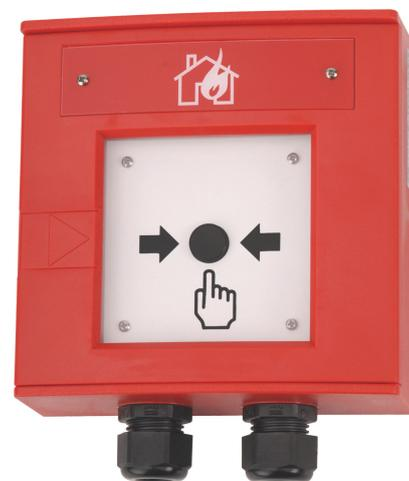
Der Handfeuermelder dC31 gemäß EN 54-11 / Typ B dient dem Einsatz in explosionsgefährdeten Bereichen. Der Zündschutz wird durch das abgedichtete Gehäuse und die vergossene Innenschaltung erreicht. Durch die gekapselte und vergossene Ausführung ist bei vorschriftenkonformer Verkabelung keine Sicherheitsbarriere erforderlich.
