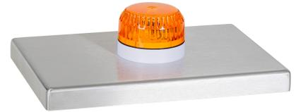
Das Säulendach DA950-2 ist aus 3 mm starkem Edelstahl mit geschliffener Oberfläche gefertigt und wurde für die Abdeckung der Schlüsseldepotsäulen SDS950-1 und SDSW950-1 konstruiert. Es ist für die Montage einer Blitzleuchte (SOLEX10x bzw. SOLEX3x) vorbereitet. Das Befestigungsmaterial ist im Lieferumfang enthalten (nicht jedoch die Blitzleuchte).
